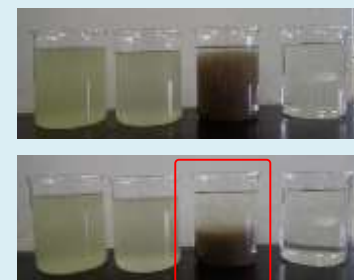
処理状況（左から流入，初沈，反応タンク，終沈）
