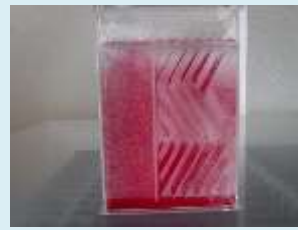
沈殿池内の傾斜板の効果
