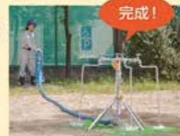
4つの蛇口から水が勢いよく出ますので、水がきれいになるまで流します(目安:3分程度)。
