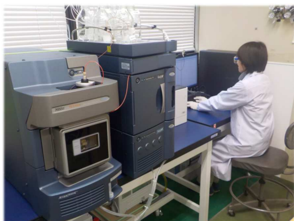
有機物を測定している様子 （液体クロマトグラフ質量分析計）
