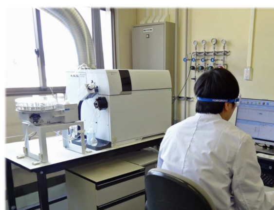
金属類を測定している様子 （誘導結合プラズマ質量分析計）
