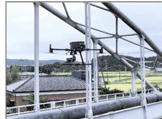
ドローンによる水管橋点検調査
